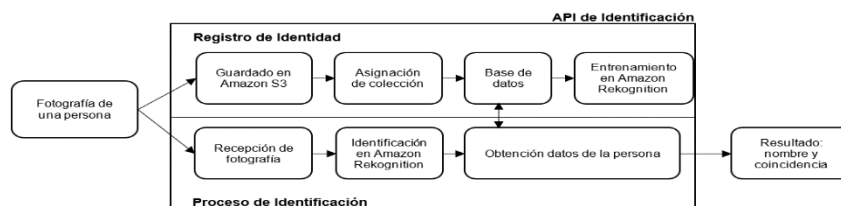
Figura 3. Proceso de operación de la API para entrenamiento e identificación de una persona.
