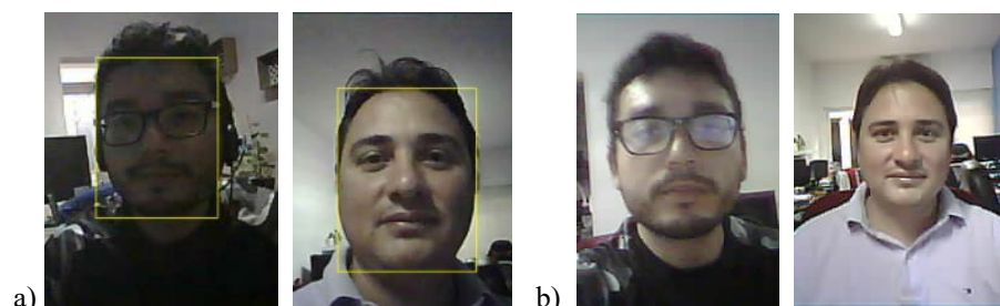
Figura 7. Fotografías de personas tomadas desde la cámara del ESP32-Cam; a) Proceso de detección de rostro, b) Fotografía obtenida de la persona
